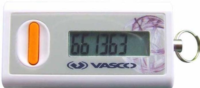
**Digipass Go 7: Das kompakte Sicherheits-Token liefert ein Einmal-Passwort. Die Dropzone wird damit zur wertlosen Daten-Müllhalde.**
