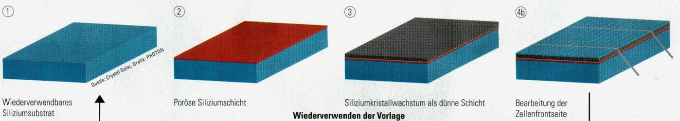
Solexel und Crystal Solar verwenden beim Aufbau ihrer Wafer ein ähnliches Prinzip. Beim Zelldesign und bei der Weiterverarbeitung zu Modulen verfolgen die beiden Unternehmen
