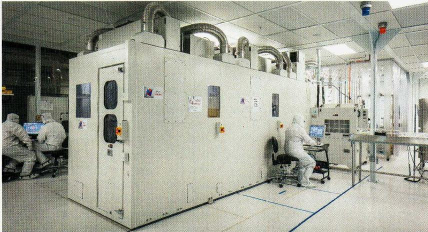
**Pilotfabriken:** Im Epitaxie-Reaktor von Crystal Solar dient eine poröse Siliziumschicht als eine Art Saat, auf der mittels chemischer Gasabscheidung ein dünner, monokristalliner Siliziumwafer wächst
