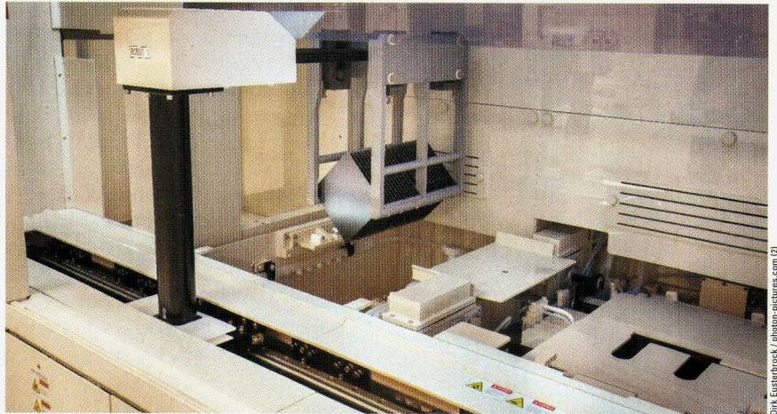
**Zerbrechlich:** Bei Solexel werden ultradünne Wafer, die noch mit dem wiederverwendbaren Substrat verbunden sind, in ein Ätzbad getaucht
